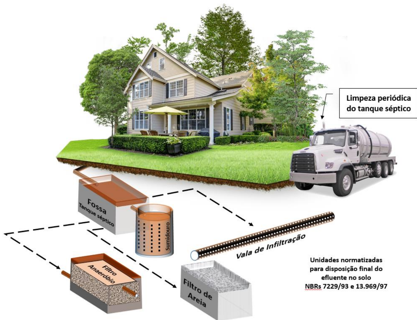
Figura 108: Unidades do Sistema Individual de tratamento de esgotos.
