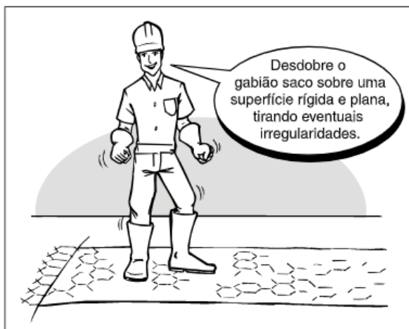
Fig.16a – Preparação de um gabião saco
