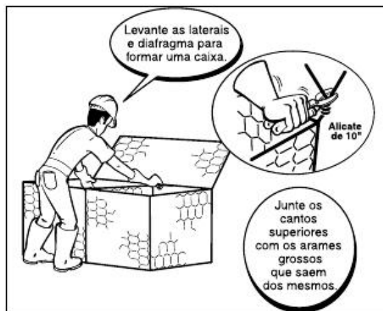
Fig.8 - Anéis laterais e diafragmas
