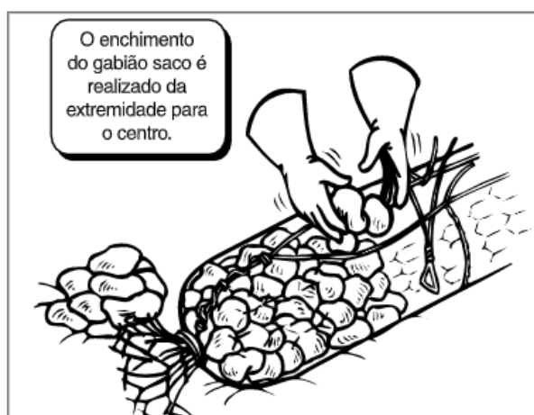
Fig. 19a – Enchimento do gabião
